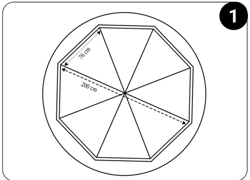
Creuser un trou de 220 cm de diamètre sur une profondeur de 10 cm.
