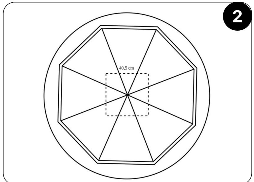
Ajouter 2 à 3 cm d'épaisseur de sable et mettre de niveau. Ajoutez votre treillis soudé découpé et surelevé de quelques centimètres.
