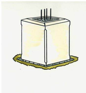
**2** - Poser la base et la remplir de mortier puis rajouter des fers en les raccordant aux fers inférieurs.
