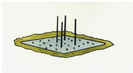
**1** - Faire une fondation de 60 x 60 cm sur 50 cm de profondeur. Préparer une semelle de béton en prenant soin de mettre des fers de 10 mm de diamètre.
